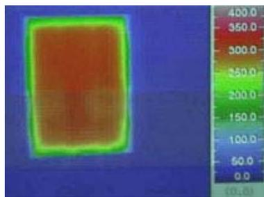
パネル温度300°Cにより、遠赤外線を効率よく放射し、火災の危険性を少なくしています。
